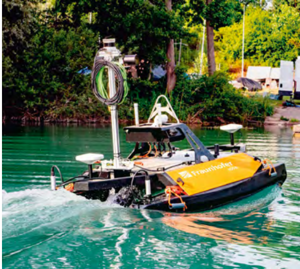
Mithilfe des Messboots kann problemlos ein 3D-Modell des Grundes angefertigt werden.
