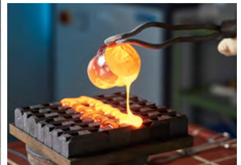
Diese Glasschmelze wird in Graphitformen gegossen und abgekühlt.
