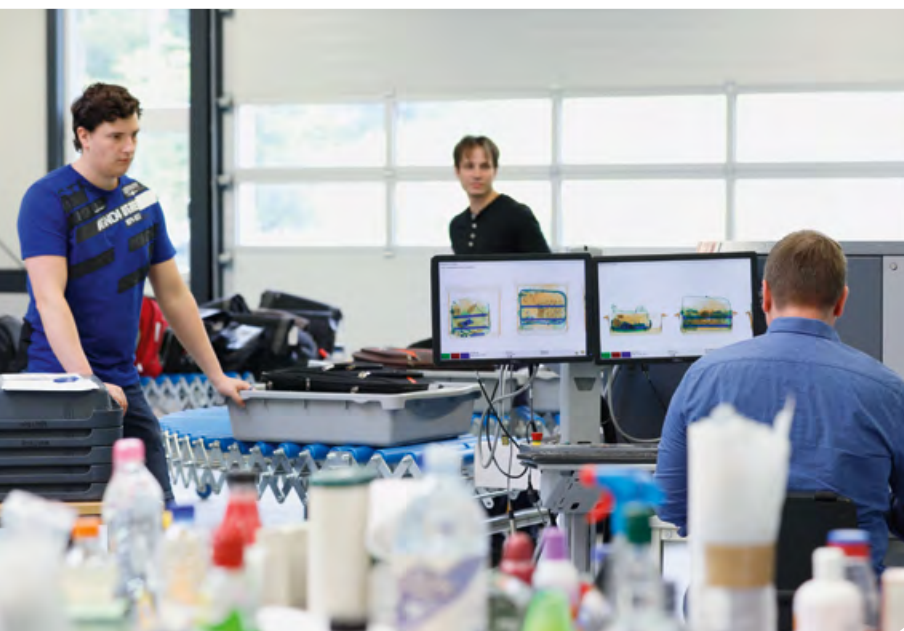
Das Team am Fraunhofer ICT prüft, ob die Gepäckscanner die in Koffern versteckten Sprengstoffe entdecken.
