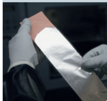
20 µm dünner Lithium-Film auf vorbehandelter Kupferfolie. © Fraunhofer IWS
