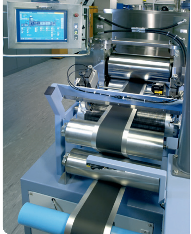
Kontinuierliche Elektrodenherstellung. © Fraunhofer ISIT
