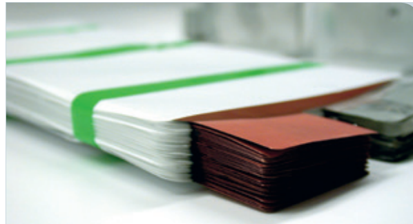
Mehrlagiger Elektrodenstapel. © Fraunhofer IFAM
