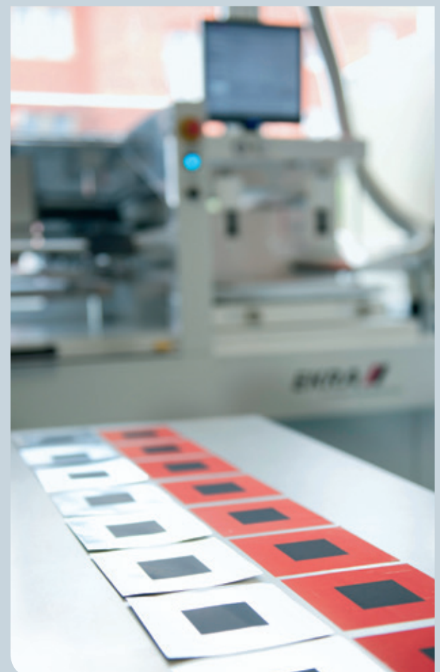
20 µm dünner Lithium-Film auf vorbehandelter Kupferfolie. © Fraunhofer IWS
