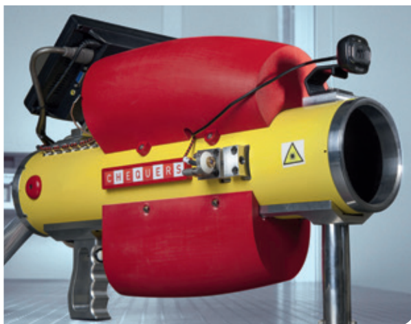
Im EU-Projekt CHEQUERS wird ein handgehaltenes System auf Basis von Quantenkaskadenlasern entwickelt, das berührungslos aus sicherer Entfernung Gefahrstoffe erkennt. © Fraunhofer IAF
