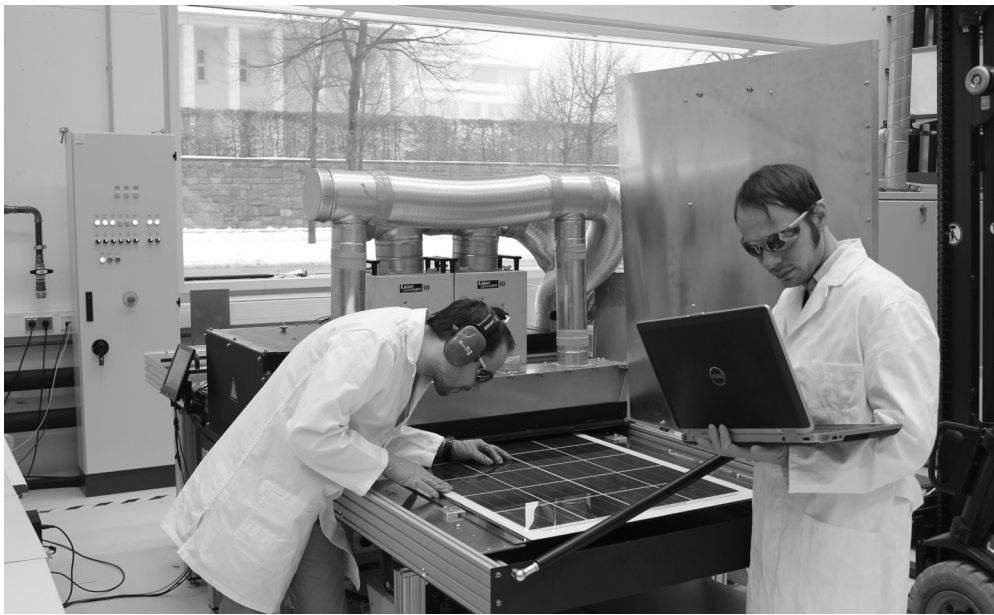
Wissenschaftler laminieren eine Solarzelle am CSP in Halle. Der Prozess ist mehr als doppelt so schnell wie bisher. (© Fraunhofer CSP) | Bild in Farbe und Druckqualität: www.fraunhofer.de/presse
